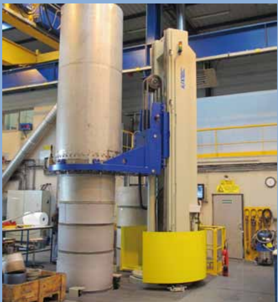
Die Ofenhaube wird mit der Hebetechnik angehoben
